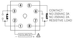
100-240VAC 50/60Hz 4.5VA 24-240VDC 1.5W
